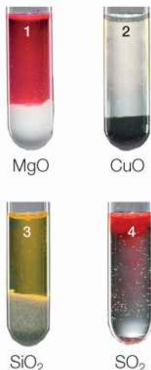
Fot. 32. Reakcja z wodą tlenków: magnezu, miedzi(II), krzemu(IV) i siarki(IV).
