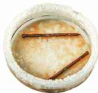
Fot. 104. Badanie wpływu na żelazo mieszaniny wody z solą.
