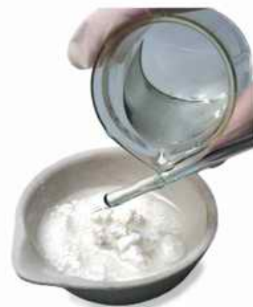
Fot. 67. Gaszenie wapna palonego.
