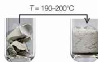
Fot. 74. Gips po ogrzaniu zmienia się w biały proszek.
