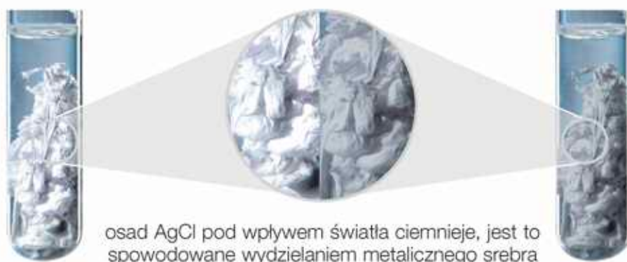
Fot. 143. Energia świetlna powoduje rozkład AgCl.
