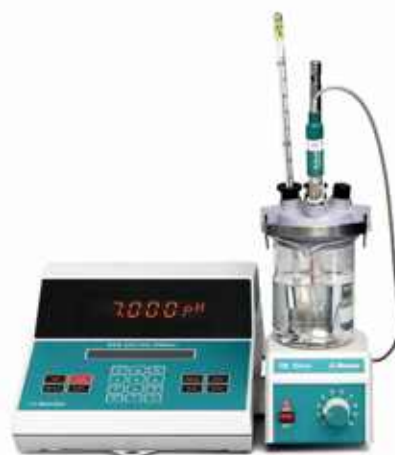
Fot. 132. Pehametr umożliwia pomiar pH z dokładnością do 0,001 jednostki.
