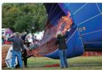
Fot. 79. Balon unosi się dzięki temu, że ogrzane powietrze, którym się napelnia wnętrze czaszy, ma mniejszą gęstość niż powietrze na zewnątrz.
