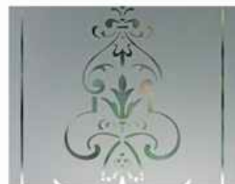
Fot. 39. Szkło matowieje pod wpływem fluorowodoru.
