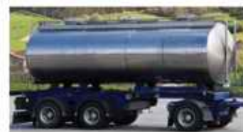
Fot. 108. Dzięki pasywacji w cysternach wykonanych z glinu można przewozić roztwory silnych utleniaczy, takich jak kwas azotowy(V).
