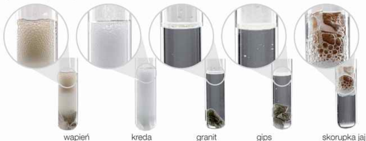
Fot. 64. Wykrywanie węglanu wapnia – pęcherzyki gazu świadczą o przebiegu reakcji chemicznej.
