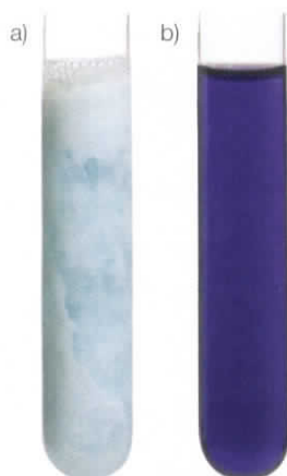
Fot. 118. Reakcja biuretowa: a) dodanie wodorotlenku miedzi(II) do białka; b) ciemnofioletowe zabarwienie roztworu.
