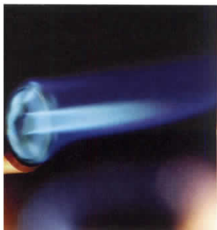
Fot. 31. Temperatura płomienia palnika acetylenowo-tlenowego wynosi ok. 3000^\circ\text{C} .
