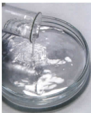
Fot. 87. Produkt reakcji estryfikacji jest cieczą o gęstości mniejszej od gęstości wody – pływa po jej powierzchni.
