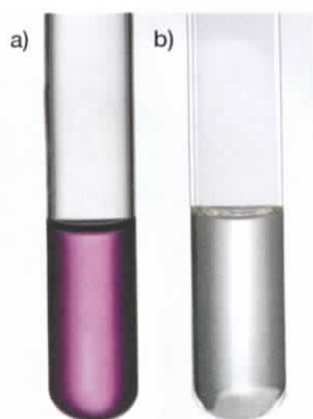
Fot. 80. Reakcja kwasu etanowego z wodorotlenkiem sodu: a) fenoloftaleina w roztworze zasady sodowej ma barwę malinową, b) pod wpływem kwasu etanowego roztwór odbarwia się.
