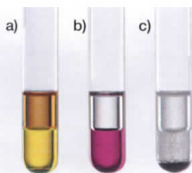
Fot. 35. Zachowanie benzenu wobec: a) wody bromowej, b) roztworu \text{KMnO}_4 , c) wody bromowej z \text{FeBr}_3 .
