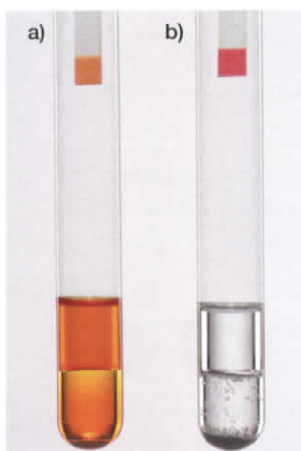
Fot. 39. Barwa uniwersalnego papierka wskaźnikowego po dodaniu wody bromowej do: a) toluenu, b) toluenu z bromkiem żelaza(III).
