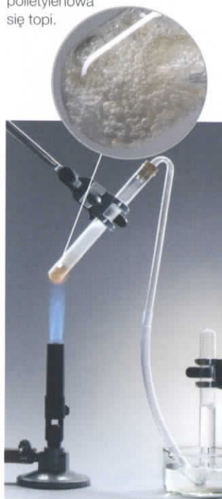
Fot. 26. Otrzymywanie etenu z folii polietylenowej.
