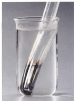
Fot. 68. Próba Tollensa – powstawanie lustra srebrnego.
