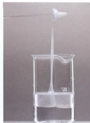
Fot. 104. Otrzymywanie nylonu na skalę laboratoryjną.
