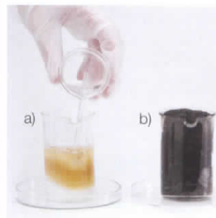
Fot. 121. Zachowanie cukru pod wpływem stężonego roztworu H_2SO_4 : a) żółknięcie, b) zwęglenie.
