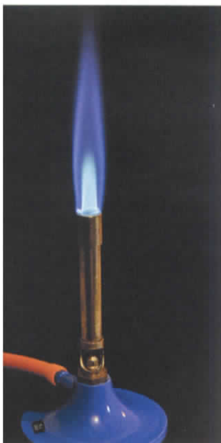
Fot. 20. Palnik gazowy stosowany w laboratorium to tzw. palnik Bunsena.
