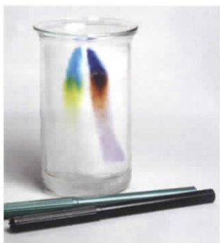
Fot. 18. Rozdzielanie tuszu na składniki metodą chromatografii.
