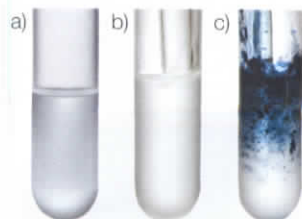
Fot. 131. Badanie właściwości skrobi: a) skrobia nie rozpuszcza się w zimnej wodzie; b) wymieszana z gorącą wodą tworzy kleik skrobiowy, c) pod wpływem jodu barwi się na ciemnoniebiesko.
