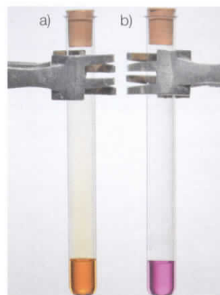
Fot. 21. Zachowanie: a) wody bromowej, b) roztworu manganianu(VII) potasu pod wpływem metanu.
