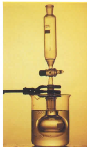
Fot. 38. Nitrowanie jest reakcją egzoenergetyczną. Zazwyczaj przeprowadza się je w temperaturze ok. 60\text{--}70^\circ\text{C} . Dlatego kolbę reakcyjną trzeba ochładzać, zanurzając ją w zimnej wodzie.
