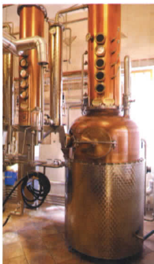
Fot. 48. Spirytus rektyfikowany otrzymuje się w specjalnych kolumnach rektyfikacyjnych wykonanych z miedzi lub stali szlachetnej.
