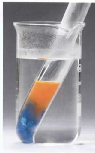
Fot. 70. Próba Trommera – niebieski Cu(OH) 2 zmienia barwę na ceglastoczerwoną.
