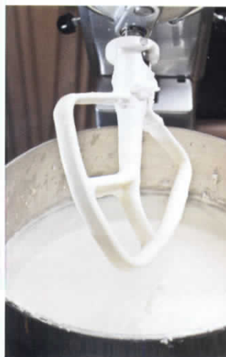
Fot. 71. Poliformaldehyd stosuje się do produkcji elementów sprzętu kuchennego, np. robotów kuchennych.
