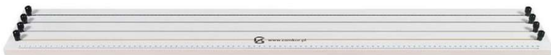
Rys. 4.1 Przyrząd do badania zależności R(l, S) i wyznaczania \rho
