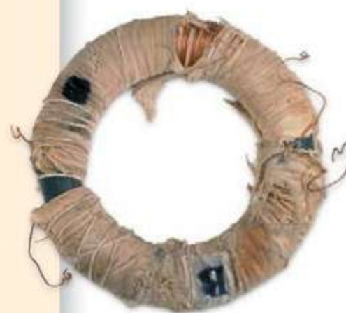
Rys. 21.1 Michael Faraday, fragment z jego dziennika, w którym uczony opisuje odkrycie indukcji elektromagnetycznej, oraz pierścień żelazny z cewkami użyty w doświadczeniu
