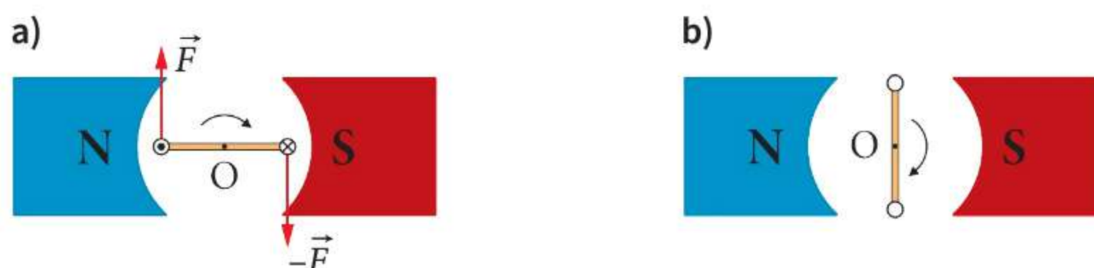
Rys. 19.2 Przekrój pionowy modelu silnika; w położeniu b następuje zmiana kierunku prądu w ramce (chwilowo prąd nie płynie)
