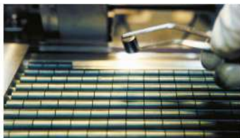
Rys. 24.1 „Tabletki” tlenku uranu wykorzystywane jako paliwo w reaktorach jądrowych. Z tabletki o masie 4,5 g uzyskuje się energię porównywalną z energią uzyskaną z 400 kg węgla w elektrowni węglowej
