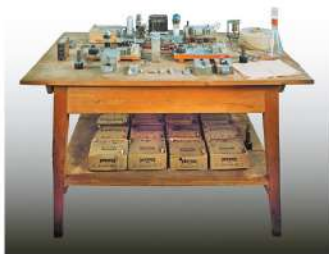
Rys. 23.4 Zrekonstruowana aparatura badawcza, użyta do uzyskania kontrolowanego rozszczepienia jąder uranu
